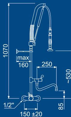
avec mitigeur monotrou thermostatique
