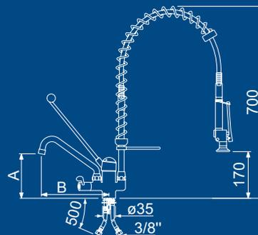
avec mitigeur monocommande 2 trous
