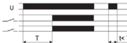
FZ18: Retardo pasando a activación (2 contactos de retardo)
