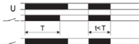
FZ19: Interconexión simétrica inicio (1 contacto retardado + 1 instantáneo)
