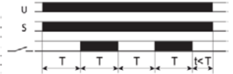
FZ32: Relé a impulso, con 2 contactos de START
