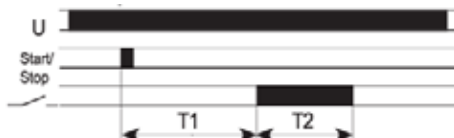
FZ41: Relé de impulso, partiendo con pausa, con contacto START/STOP
