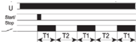
FZ40: Relé de impulso, partiendo con pausa, con contacto START/STOP
