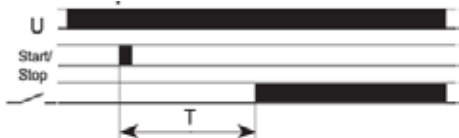
FZ38: Retardo de activado con contacto START/STOP
