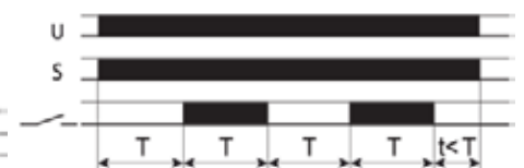
FZ31: Temporisé, démarre en pose avec contact de commande
