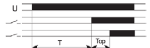
FZ31: Temporisé, démarre en pose avec contact de commande
