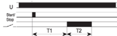
FZ41: Donneur d'impulsion avec poussoir marche/arrêt
