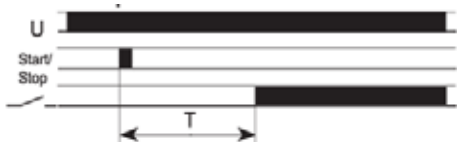
FZ38: Retard mise sous tension avec poussoir marche/arrêt
