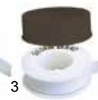
3 | 890013 | Nastro in PTFE "Goldband", rotolo Lunghezza 13,3m, larghezza 12,7mm, 142g/m <sup>2</sup> , da -240 a +260°C termoresistenze, certificazione DVGW KTW |
