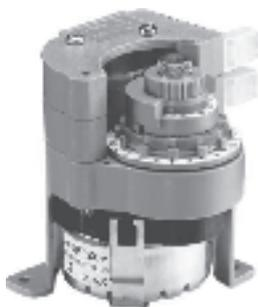
Programmatori ciclici utilizzabili per svolgere funzioni di sbrinamento in impianti di refrigerazione. Il numero di sbrinamenti in 24 ore ed il tempo di sbrinamento sono programmabili dall'utente da 2 a 60 min. E' possibile inoltre programmare il tempo di ritardo per le ventole da 2 a 14 min.
