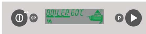
Le bouton **2 (SÉLECTION DES PROGRAMMES SPÉCIAUX)** permet de faire défiler les options et de les activer et/ou désactiver avec les boutons **3 e 4 (SÉLECTION DES PROGRAMMES et START)**.
