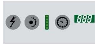
Mit der Taste **1 (ON/OFF)** können Sie die Menüpunkte abrollen und jeweils mit den Tasten **2 und 3 (PROGRAMMWahl und START)** aktivieren und/oder ändern. Folgende Optionen können eingeblendet werden:
