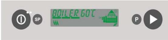
Nel caso in cui la vostra apparecchiatura sia dotata di un display LCD è necessario verificare la compatibilità tra il Firmware della scheda e della pulsantiera.
