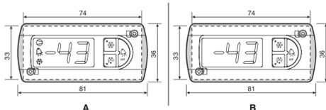
Nota: In figura A e B, sono rappresentate le due versioni dello strumento. La prima rispettivamente presenta il LED di stato all'interno dell'area display, la seconda sui tasti siliconici retroilluminati.
