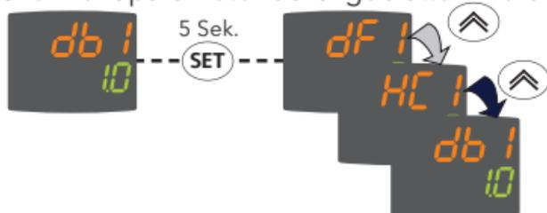
Den gewünschten Parameter mit den Tasten **⏶** und **⏷** wählen. Zur Änderung des Werts die Taste **set** drücken. Das Label des Parameters blinkt auf. Den (auf der zweiten Zeile) angezeigten Wert mit den Tasten **⏶** und **⏷** ändern und den neuen Wert mit den Tasten **set** oder **fnc** übernehmen.
