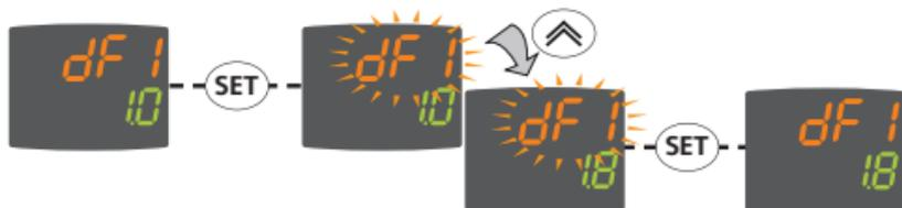
**HINWEIS:** Das Gerät sollte nach jeder Änderung der Parameterkonfiguration aus- und wieder eingeschaltet werden, um Betriebsstörungen bezüglich der Konfiguration und/oder laufender Zeitsteuerungen vorzubeugen.
