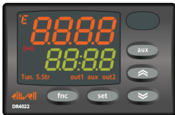
**HINWEIS:** Bei BLINKEN der "oberen" DISPLAYANZEIGE **PV** kann der an der "unteren" DISPLAYANZEIGE **SV** eingblendete Wert geändert werden.
