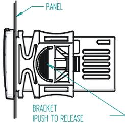
Los instrumentos deben ser montados en panel, en una perforación de 29x71 mm, y fijados usando las fijaciones que se acompañan.
