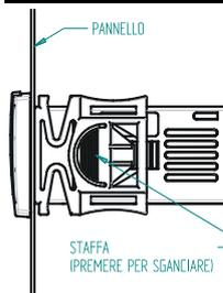
Gli strumenti vanno montati su pannello **verticale**, su foro 29x71 mm, e fissati con le apposite staffe in dotazione.
