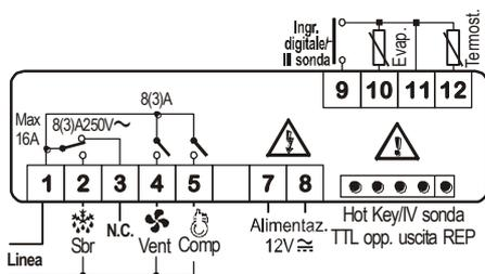
NOTA: Il relè compressore è da 8(3)A o 16(6)A a seconda del modello. 24Vac/dc: connettere l'alimentazione ai morsetti 7 e 8.
