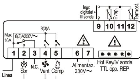
NOTA: Il relè compressore è da 8(3)A o 16(6)A a seconda del modello. 120Vac: connettere l'alimentazione ai morsetti 6 e 7.
