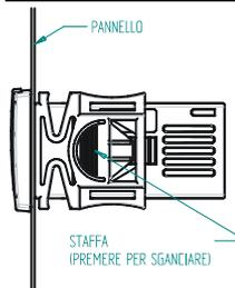
Gli strumenti vanno montati su pannello **verticale**, su foro 29x71 mm, e fissati con le apposite staffe in dotazione.
