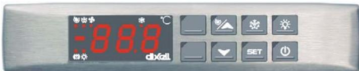
**set** Per visualizzare o modificare il set point. In programmazione seleziona un parametro o conferma un valore. Se premuto per 3 sec durante la visualizzazione della MAX o della min temperatura le resetta.
