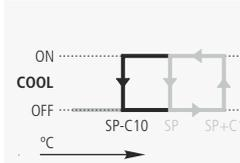
Al activar este modo, el compresor comienza a funcionar hasta que la temperatura en la sonda 1 alcanza el valor del punto de ajuste, menos la variación indicada en el parámetro C10.
