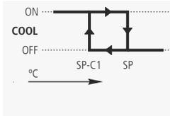
Cuando la temperatura en sonda 1 alcanza el valor del punto de ajuste (SP) menos el diferencial de la sonda (C1), el relé COOL se activa, alimentando las resistencias calefactoras y haciendo que la temperatura aumente. Una vez alcanzado el valor del punto de ajuste (SP), el relé COOL se desactiva, cortando la alimentación de las resistencias.
