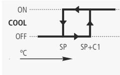
Cuando la temperatura en sonda 1 alcanza el valor del punto de ajuste (SP) más el diferencial de la sonda (C1), el relé COOL se activa, arrancando el compresor y haciendo que la temperatura descienda. Una vez alcanzado el valor del punto de ajuste (SP), el relé COOL se desactiva, deteniendo el compresor.
