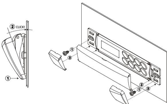
**MONTAGE DER FRONTELEMENTE BEI PLIXIGLASFRONT ZUM RUNTERKLAPPEN**
