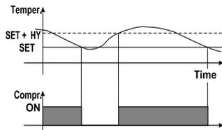
Bei Fühlerfehler wird automatisch ein Verdichter-Zyklusbetrieb gestartet. Parameter "CO" (Einschaltdauer) und "COF" (Ausschaltdauer).
