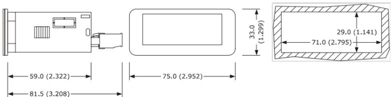
59,0 (2,322) es la profundidad con borneras fijas de tornillo; 81,5 (3,208) es la profundidad con borneras extraíbles de tornillo.
