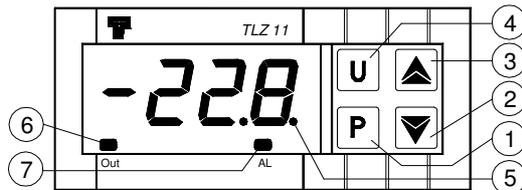
**1 - Tasto P** : Utilizzato per l'impostazione del Set point e per la programmazione dei parametri di funzionamento
