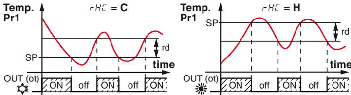
Relativamente al modo di funzionamento programmato al parametro  $rHC$  il differenziale viene considerato automaticamente dal regolatore con valori positivi per un controllo di Refrigerazione ( $rHC = C$ ) o con valori negativi per il controllo di Riscaldamento ( $rHC = H$ ).
