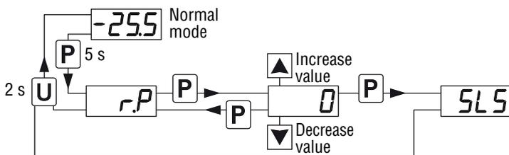
**Note:** Qualora venga dimenticata la Password per accedere ai parametri utilizzare la seguente procedura: togliere e ridare alimentazione allo strumento, premere il tasto (P) durante il test iniziale del display mantenendo premuto il tasto oltre 5 s. Si avrà così accesso ai parametri protetti e si potrà quindi verificare e modificare anche il parametro  $\epsilon^{PP}$ .
