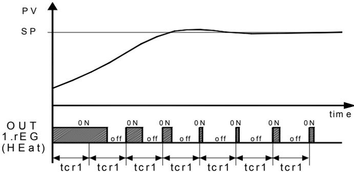
Per ottenere una buona stabilità della variabile in caso di processi veloci, il tempo di ciclo "tcr1" deve avere un valore basso con un intervento molto frequente dell'uscita di regolazione.
