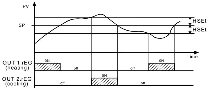
Nel caso in cui l'uscita 2.rEG venga utilizzata per il comando di un compressore è prevista la funzione di protezione compressore da partenze ravvicinate.
