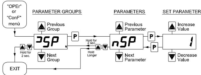
**ATTENZIONE:** Lo strumento viene programmato in fabbrica con tutti i parametri, ad eccezione del Set Point "SP1" (e 2,3,4), programmabili nel menù "CONF" allo scopo di prevenire errate programmazioni accidentali da parte di utenti non esperti.
