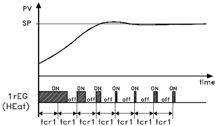
Para tener una buena estabilidad de la variable de proceso, en casos de procesos rápidos, el tiempo de ciclo "tcr1" debe tener un valor bajo una frecuente actuación de la salida de control.
