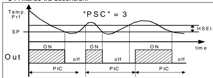
Attraverso il parametro "LCt" è anche possibile stabilire il tempo minimo di attivazione dell'uscita in modo da evitare accensioni troppo brevi del compressore.
