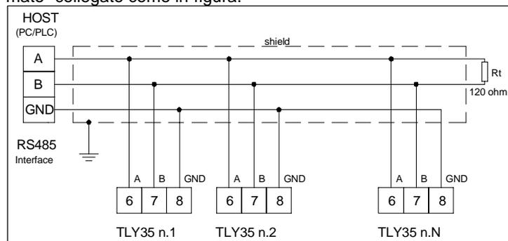
Se lo strumento è dotato di interfaccia seriale deve essere programmato al par. "Add" (nel gruppo di parametri "SER") l'indirizzo della stazione.
