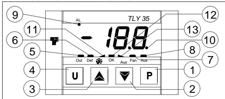
**1 - Tasto P** : Utilizzato per l'impostazione del Set point e per la programmazione dei parametri di funzionamento
