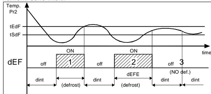
**Esempi:** lo sbrinamento 1 termina per raggiungimento della temperatura "tEdF", lo sbrinamento 2 termina allo scadere del tempo "dEFE" in quanto la temperatura "tEdF" non viene raggiunta, lo sbrinamento 3 non avviene in quanto la temperatura è superiore a "tSdF".
