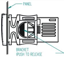
Die Tafelbau-Geräte XR60C sind für einen Ausschnitt 71x29 mm vorgesehen und werden mit zwei Befestigungsbügel fixiert. Die Befestigungsbügel von hinten aufschieben und durchschieben bis beide Bügel fest einrasten.
