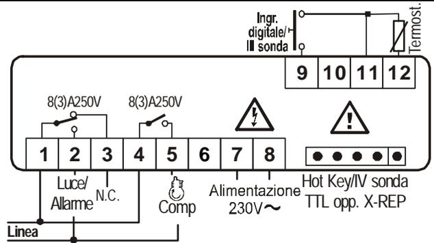
Bei 9-40Vdc, 12Vac/dc, 24Vac/dc, 110Vac und 230Vac: Anschlüsse 7 und 8.
