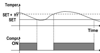
La régulation est obtenue par la température mesurée par la sonde d'ambiance avec un différentiel positif par rapport au point de consigne: lorsque la température augmente et atteint le point de consigne plus le différentiel, alors le compresseur démarre. Il s'arrête lorsque la température atteint de nouveau le point de consigne.
