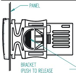
Los instrumentos deben ser montados en panel, en una perforación de 29x71 mm, y fijados usando las fijaciones que se acompañan.
