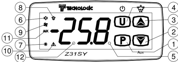
**1 - Taste P** : Durch kurzes Drücken dieser Taste wird der Zugriff auf die Einstellung des Sollwertes ermöglicht.
