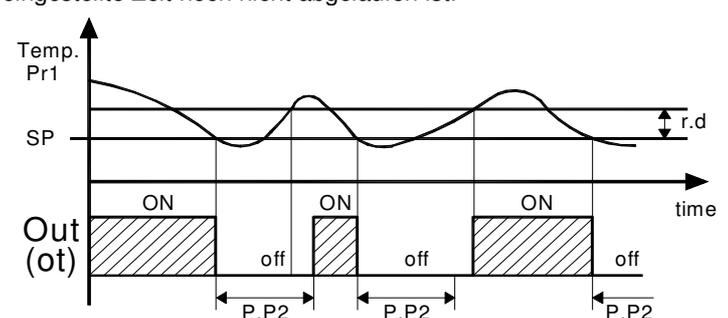
Die dritte Steuerung beinhaltet eine Aktiviersperre des Ausgangs "ot", wenn seit Aktivierung des Ausgangs die im Parameter "P.P3" eingestellte Zeit noch nicht abgelaufen ist.
