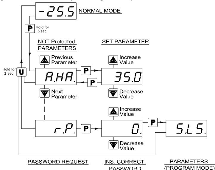
Wurden bei aktivem Passwort einige Parameter als "nicht geschützt" konfiguriert, zeigt das Gerät bei Zugriff auf die Programmierung zunächst alle "als nicht geschützt" konfigurierten Parameter an und zuletzt den Parameter "r.P", über den man Zugriff auf die "geschützten Parameter" erhält.
