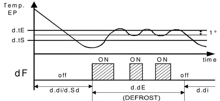
**Beispiel für einen elektrisch temperierten Abtauzyklus:** Der Abtauzyklus endet nach Ablauf der Zeit "d.dE". Während des Abtauzyklus schaltet sich der als dF konfigurierte Ausgang ein/aus, wie eine Temperaturüberwachung mit Regelung EIN/AUS im Heizbetrieb mit 1° Hysterese, um die Abtautemperatur beim eingetragenen Wert "d.tE" konstant zu halten.
