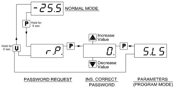
**Hinweis:** Wurde das Passwort für den Zugriff auf die Parameter vergessen, ist wie folgt beschrieben vorzugehen: Das Gerät spannungsfrei machen und wieder unter Spannung setzen, die Taste P während des Display-Starttests drücken und mind. 5 Sek. gedrückt halten. Daraufhin gibt das Gerät den Zugriff auf die geschützten Parameter frei und der Parameter "t.PP" kann geprüft und verändert werden.
