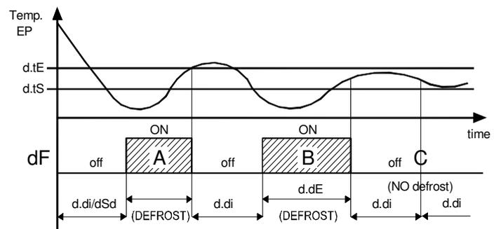
**Beispiele für das Abtauen:** Der als A gekennzeichnete Abtauzyklus endet, nachdem die Temperatur "d.tE" erreicht wurde, der Abtauzyklus B endet nach Ablauf der Zeit "d.dE", da die Temperatur "d.tE" nicht erreicht wurde, der Abtauzyklus C erfolgt nicht, da die Temperatur höher als "d.tS" ist.
