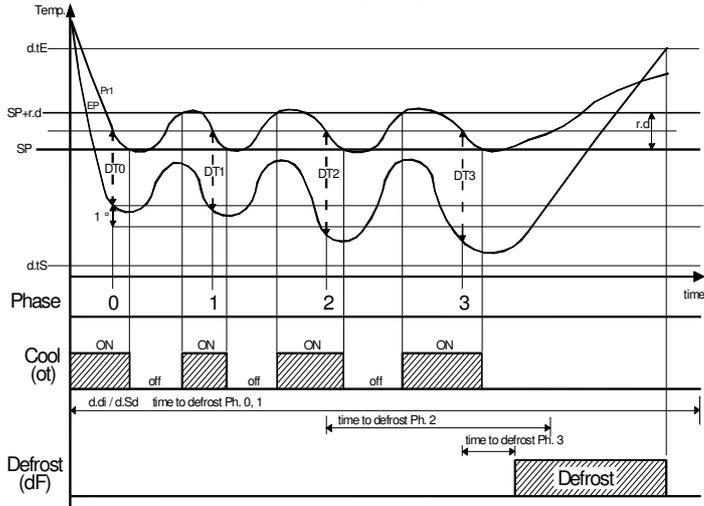
**Betriebsbeispiel "dynamic defrost intervals system" mit Reduzierung "d.dd" = 40 % und durch die Temperatur bestimmtes Abtauen.**
