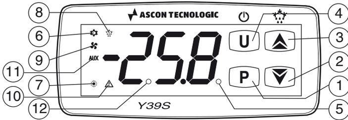
1. **Tecla  $\square$  P:** Pulsando y soltando, programación del valor de regulación (Set Point). Manteniendo durante 5 segundos, entrada al menú configuración y pulsando nuevamente se confirma el valor de los parámetros. Presionando junto a la tecla "Subir" cuando el teclado esta bloqueado permite el desbloqueo teclado.
