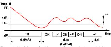
Exemple de dégivrage électrique avec fonction de thermostat: le dégivrage s'arrête à la fin des temps "d.dE". Pendant le dégivrage de la sortie configurée comme dF est activé/deconnecté comme un contrôleur de température tout ou rien en mode chauffage avec hystérésis de 1 ° afin de maintenir une température de dégivrage constante a la valeur "d.tE".
