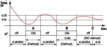
Exemples du fin dégivrage: le dégivrage A termine pour la réalisation de la température "d.tE", le dégivrage C termine à la fin du temps "d.dE" car la température "d.tE" n'est pas réalisée, le dégivrage C ne s'effectue pas car la température est supérieure à
