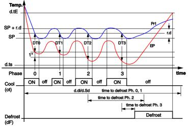
"réduction d.dd" = 40% et fin de dégivrage par température.
