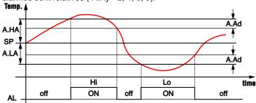
Les alarmes de température de maximum et de minimum peuvent être déconnectées en établissant les paramètres relatifs "A.HA" et "A.LA" = oF.
