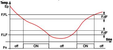
Note: Une attention particulière devrait être la correct utilisation des fonctions de contrôle des ventilateurs en fonction de la température parce que dans une application typique du ventilateur de l'évaporateur de réfrigération s'arrête bloquant le transfert de chaleur.
