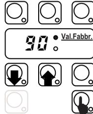
**Bild 19 Ändern Dauer (Tank LED zeigt Standardwert an).**
