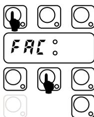
**Bild 5 Zugang zu den Werksparametern (Tasten mindestens 5 Sek. drücken)**
