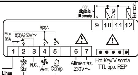
NOTA: Il relè compressore è da 8(3)A o 16(6)A a seconda del modello.
