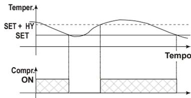
Il relè del compressore viene attivato per mantenere una determinata temperatura fissata dal set point. L'isteresi Hy è automaticamente sommata al set point. Se la temperatura aumenta e raggiunge il set point più l'isteresi, il compressore viene attivato, per essere poi spento quando la temperatura si riporta al valore del set point. (vedi figura)
