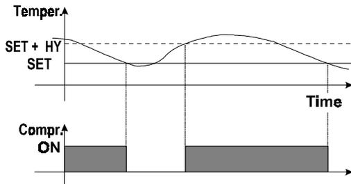
Bei Fühlerfehler wird automatisch ein Verdichter-Zyklischerbetrieb gestartet. Parameter "CO" (Einschaltdauer) und "COF" (Ausschaltdauer).
