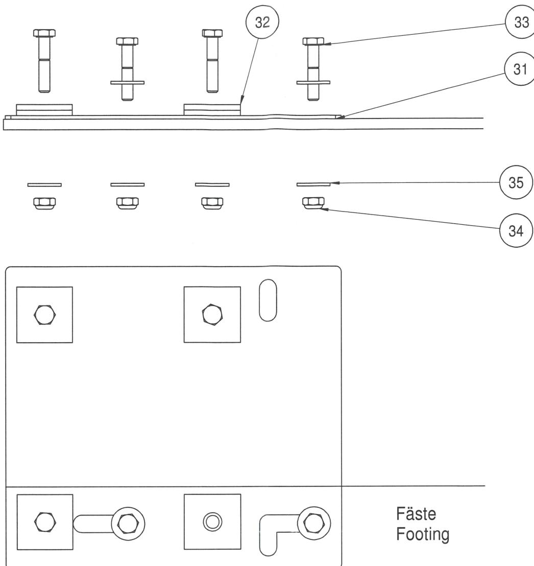
Börja med att montera fästplattan på fästet
