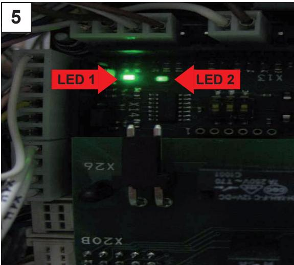
Zur Kontrolle Füllvorgang starten, Leuchtkraft LED 1 (Tür-/Haubenschalter) mit der LED 2 vergleichen. Die LED 2 (Flügelradzähler) leuchtet eindeutig schwächer!
