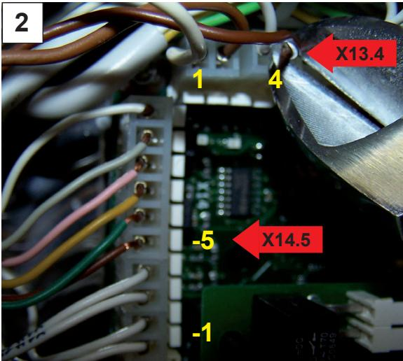
Hierzu die Ader X13.4 (+12V) entfernen und mit Hilfe der roten Schniedklemme mit der Ader X14.5 (+5V) verbinden.
