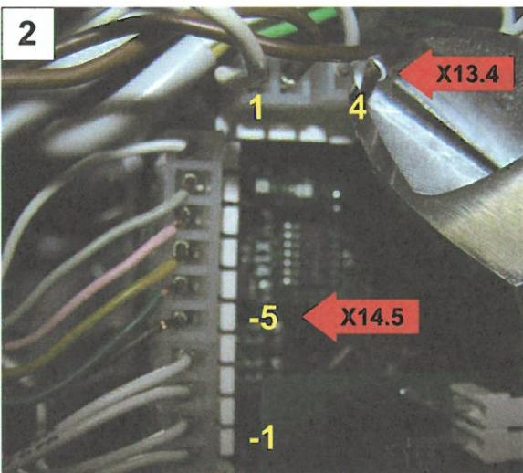
Hierzu die Ader X13.4 (+12V) entfernen und mit Hilfe der roten Schneidklemme mit der Ader X14.5 (+5V) verbinden.
