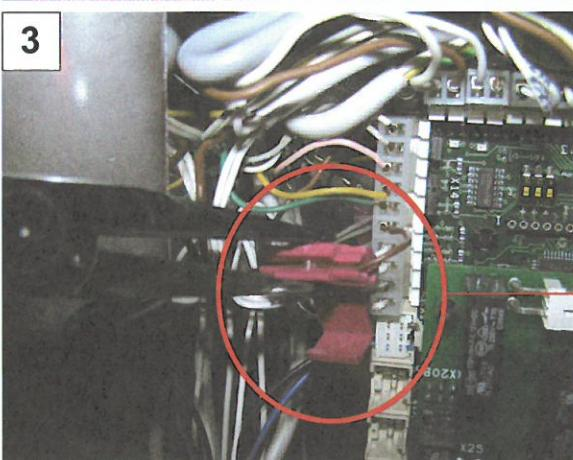
Die Adern dürfen nicht abisoliert werden. Adern in die Schneidklemme führen und mit einer Zange zusammenpressen.
