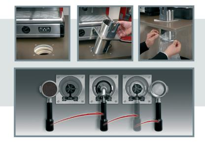
Inserendo il portafiltro nell'incastro del Pro - Fondi inizia a ruotare una spazzolina accoppiata ad un motore elettrico da 12 VDC. Il portafiltro viene perfettamente pulito senza rumore e stress dell'operatore. Il fondo del caffè cade direttamente nel sacco sotto al banco. In questo modo si eliminano i cattivi odori e si mantiene perfettamente pulito il banco di lavoro a vista del cliente, con un sostanziale miglioramento dell'igiene dell'ambiente e di lavoro.
