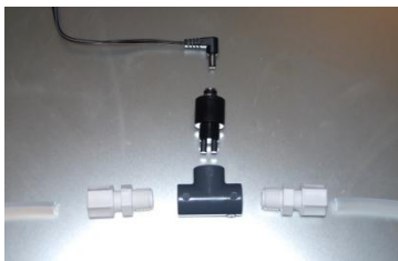
MONTAGGIO E COLLEGAMENTO DEL RACCORDO A T CON IL TUBO DI ASPIRAZIONE SALAMOIA E LA CELLA IN TITANIO DEL GENERATORE DI CLORO...
