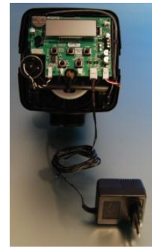
COLLEGAMENTO STANDARD DELL'ALIMENTATORE SENZA GENERATORE DI CLORO
