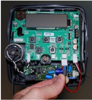
RELIER LE CÂBLE DU GÉNÉRATEUR DE CHLORE COMME LA FIGURE LE MONTRE
