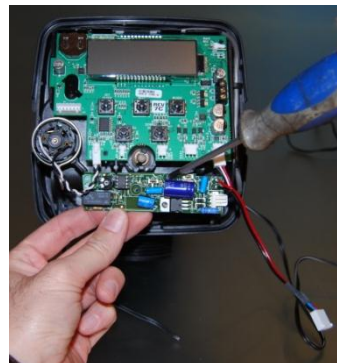
FIXER LA CARTE ÉLECTRONIQUE DU GÉNÉRATEUR DE CHLORE AVEC LES DEUX VIS EN DOTATION
