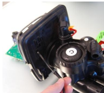
SMONTARE LA SCHEDA ELETTRONICA
