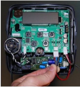
CONECTAR EL CABLE DEL GENERADOR DE CLORO COMO ILUSTR LA FIGURA
