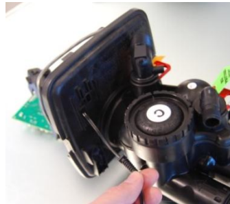
DÉPOSER LA CARTE ÉLECTRONIQUE
