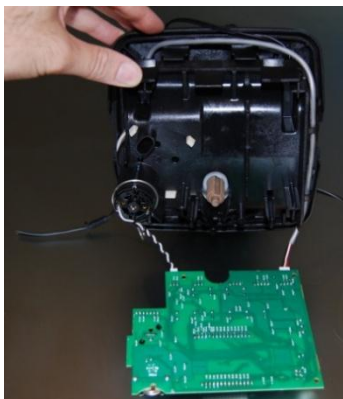
DIE HALTERUNG DER LEITERPLATTE EINSETZEN
