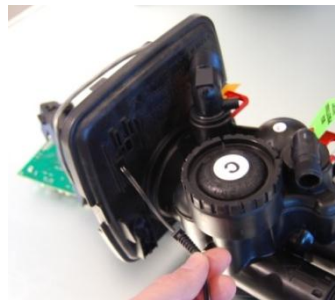
DIE LEITERPLATTE ENTFERNEN
