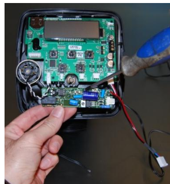
BLOQUEAR EL CIRCUITO IMPRESO DEL GENERADOR DE CLORO CON LOS DOS TORNILLOS SUMINISTRADOS
