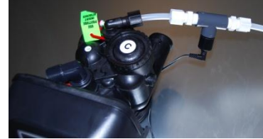
...SUR LE TUYAU À L'ENTRÉE ET RÉTABLISSEMENT NIVEAU SAUMURE
