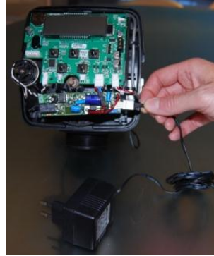
DAS VERSORGUNGSKABEL ANSCHLIESSEN, WIE IN DER ABBILDUNG DARGESTELLT
