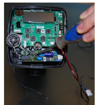
DAS KABEL DURCH DEN ENTSPRECHENDEN STECKPLATZ VERLEGEN
