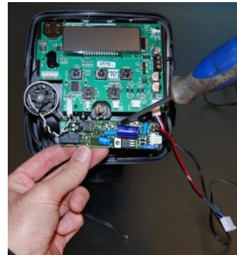
BLOQUEAR EL CIRCUITO IMPRESO DEL GENERADOR DE CLORO CON LOS DOS TORNILLOS SUMINISTRADOS
