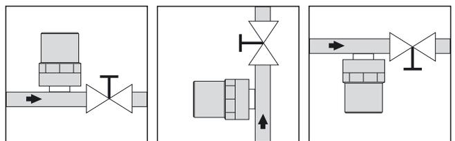
Der Caleffi-Wasserschlagdämpfer der Serie 525 muss möglichst nahe an der Vorrichtung installiert werden, die durch das schnelle Unterbrechen des Wasserflusses den Wasserschlag verursacht, damit der erzeugte Überdruck schnellstmöglich gedämpft wird. Er kann sowohl waagrecht als auch senkrecht oder hängend eingebaut werden.
