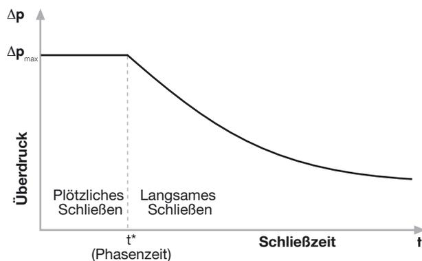
Beispiel mit Zahlen: Rohrlänge 10 m, Durchmesser für 1/2", Rohre aus Stahl, Kupfer und PE-X mit Wassergeschwindigkeit  $v_1 = 2$  m/s. Es ergeben sich die folgenden Werte für die Ausbreitungsgeschwindigkeit der Störung  $v_2$ , die Zeiten für das „schnelle“ Schließen  $t^*$  (Phasenzeit) und den Überdruck  $\Delta p$  anhand der Formeln.
