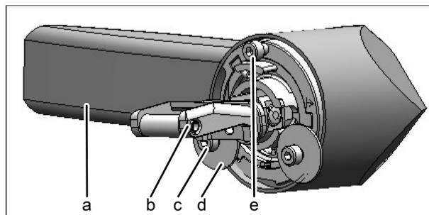
Figure: Serrure de porte et position de montage de la poignée de porte
