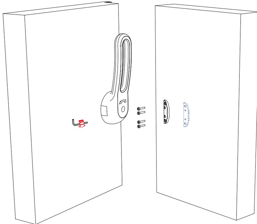
5. Schließblech evtl. mit Unterlage **Optional** (Stärke 3 mm) nach Angaben montieren.
