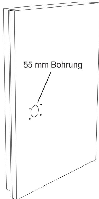
1. Bohrung für Verschluss nach Lochbild fertigen.
