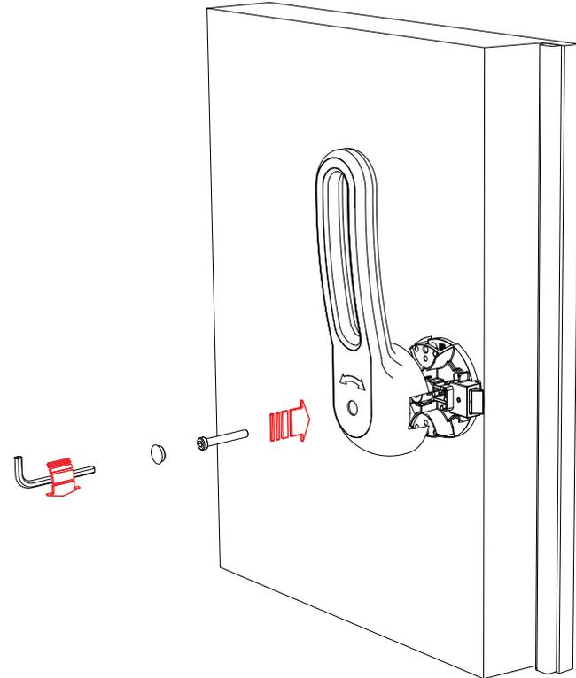
3. Die Hebelaufnahme muss je nach DIN Richtung durch verdrehen des Innenflanschs vor eingestellt werden.
