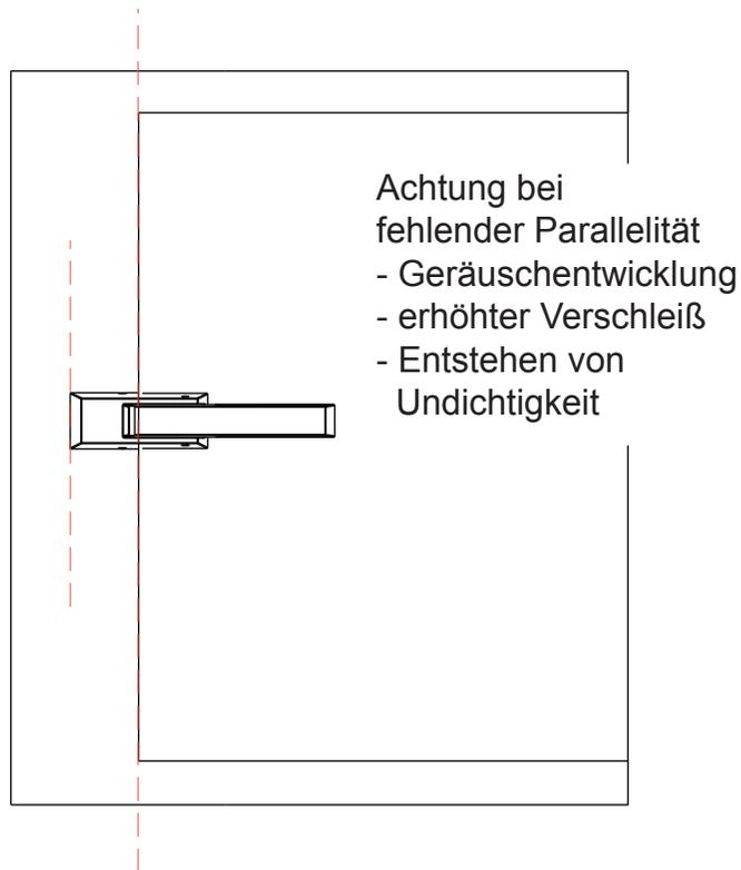
4. Verschlüsse montieren und Schrauben festziehen, dabei auf Parallelität der Bauteile (z.B. Kloben zu Verschluss) achten.
