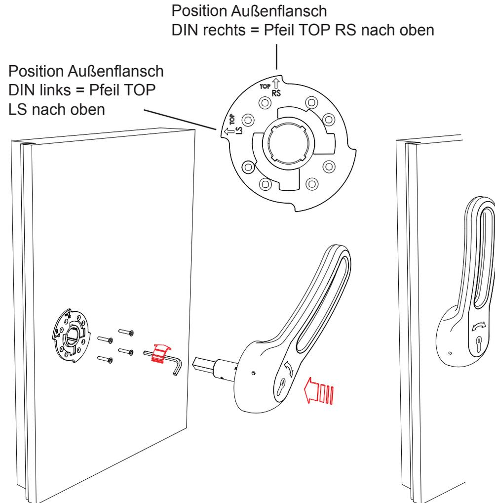
2. Den Außenflansch mit 4 Senkschrauben (nicht im Lieferumfang) befestigen. Außenverschluss DIN links unter 45° nach links / DIN rechts unter 45° nach rechts in den Außenflansch bis zum Anschlag einschieben und in senkrechter Stellung zurück drehen.
