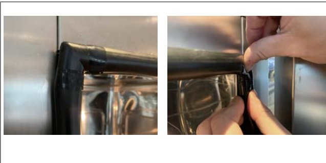
Bild: Dichtung zuerst oben an den Ecken einsetzen
