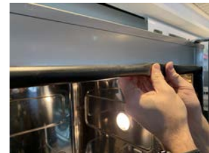
Bild: Dichtung immer von der Mitte nach außen eindrücken
