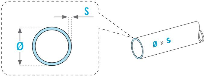
Ø = 管道外径      S = 管道壁厚度
