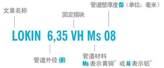
\*对于铜管道，使用 Ms 固定插块，对于铝管道，使用 Al 固定插块。
