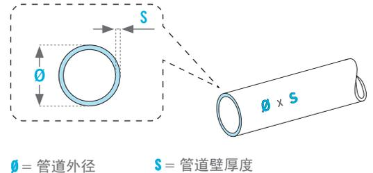
**1** 插入适用于材料、管道外径  $\varnothing$  和管道壁厚  $S$  的固定插块(03)。如果使用工作压力低于 25 巴的冷却剂(例如, R134a 汽车空调系统或冰柜), 则不必使用固定插块。
