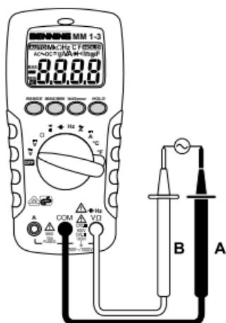
Bild 3: Wechselspannungsmessung
