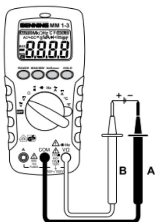
Bild 2: Gleichspannungsmessung
