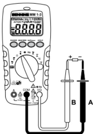
Bild 8: Durchgangsprüfung mit Summer
