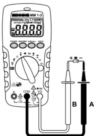
Bild 7: Diodenprüfung
