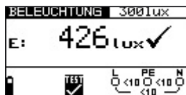
Abb. 5.52: Beispiel eines Ergebnisses der Beleuchtungsmessung
