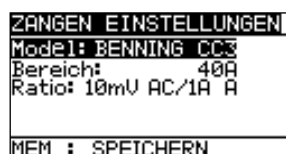
Abbildung 4.12: Einstellung des Stromzangen-Messeingangs
