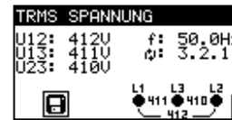
Abbildung 5.4: Beispiele für Spannungsmessungen im Einphasen- und Dreiphasensystem
