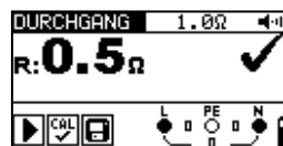
Abbildung 5.10: Beispiel Niederohmmessung R LOW \Omega
