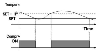
La regulación se realiza de acuerdo a la temperatura medida por la sonda termostática con un diferencial positivo respecto del punto de intervención (set point): si la temperatura aumenta y alcanza el valor del punto de intervención más el diferencial el compresor arranca para detenerse cuando la temperatura alcanza nuevamente del valor correspondiente al punto de intervención.
